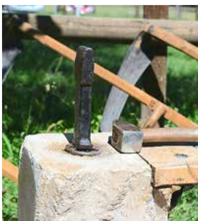
Sensenvielfalt: Je nach Gelände, Mähfläche und Mähgut setzt man eine andere Sense ein. Auf den zwei Bildern rechts: ein Dengelamboss, an dem die Sensenblatt-Schneide mit einem Hammer «ausgetrieben» (verdünnt) und gehärtet wird.
