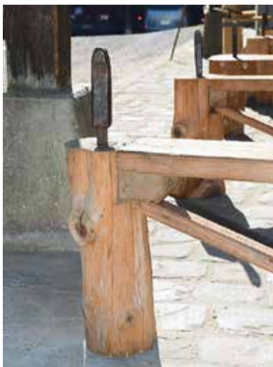
Sensenvielfalt: Je nach Gelände, Mähfläche und Mähgut setzt man eine andere Sense ein. Auf den zwei Bildern rechts: ein Dengelamboss, an dem die Sensenblatt-Schneide mit einem Hammer «ausgetrieben» (verdünnt) und gehärtet wird.
