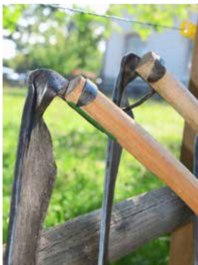
Sensenvielfalt: Je nach Gelände, Mähfläche und Mähgut setzt man eine andere Sense ein. Auf den zwei Bildern rechts: ein Dengelamboss, an dem die Sensenblatt-Schneide mit einem Hammer «ausgetrieben» (verdünnt) und gehärtet wird.
